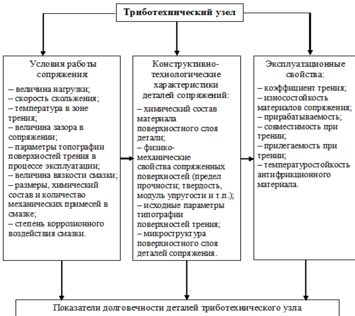
Рис. 2. Блок-схема анализа факторов, влияющих на долговечность узла трения
