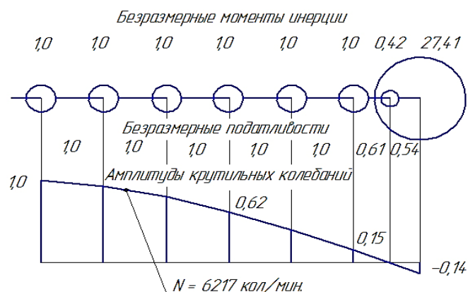
Рис. 3. Результаты расчета свободных колебаний дизеля Wartsila 6L20 без демпфера
