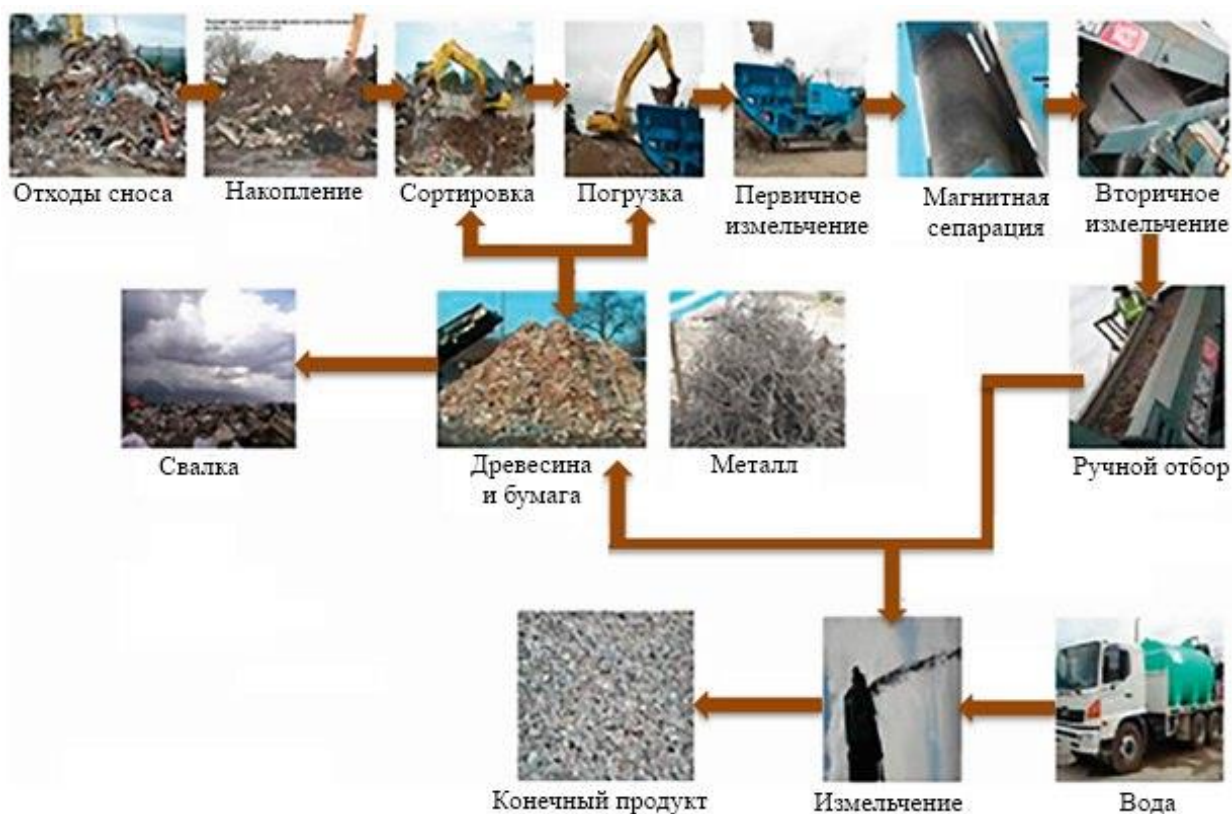
Рис. 3. Процесс переработки бетонного лома
