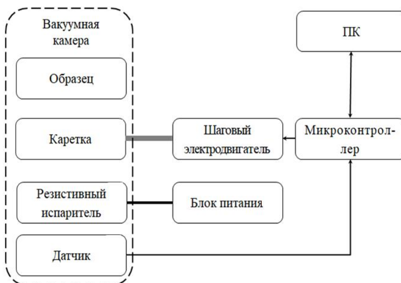
Рис. 1. Структурная схема устройства для реализации метода термодиффузии со сменой прецизионных масок (из заявки Роспатент № 2024135444 от 27.11.2024)
