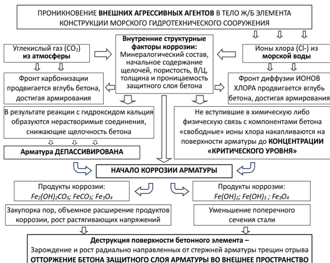
Рис. 4. Схема механизмов химической коррозии арматуры в железобетоне
