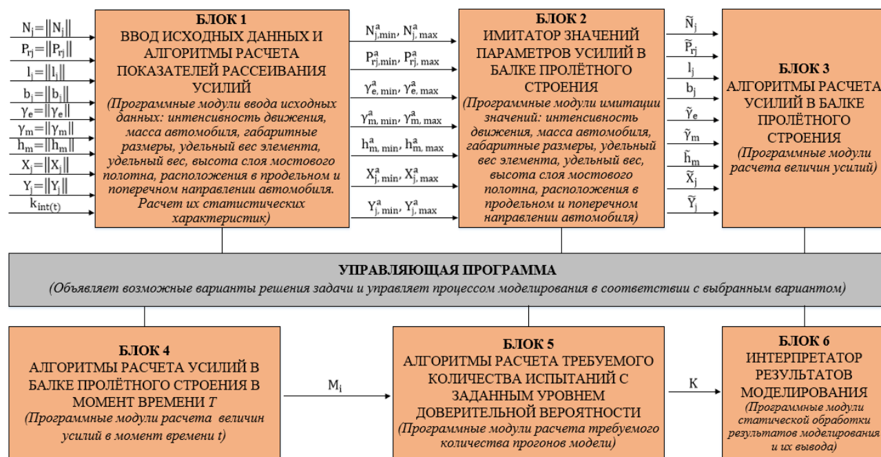
Рис. 3. Блок-схема имитационной модели работы главной балки пролётного строения
