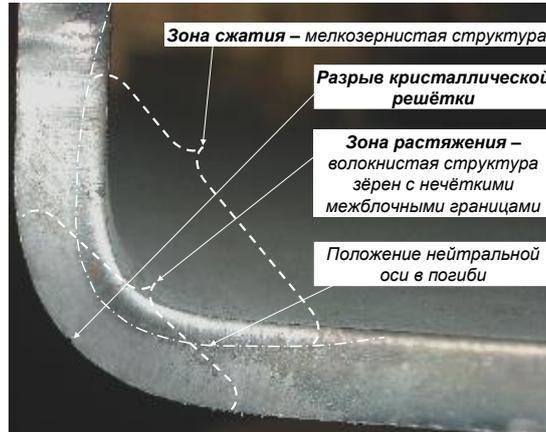
Рис. 10. Результат холодной угловой гибки с дефектами в кристаллической решётке
