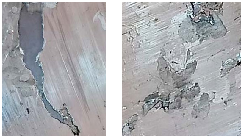
Рис. 1. Отслоение и выкрашивание антифрикционного слоя
