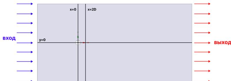
Рис. 5. Схема расчетной области с обозначением сечений
