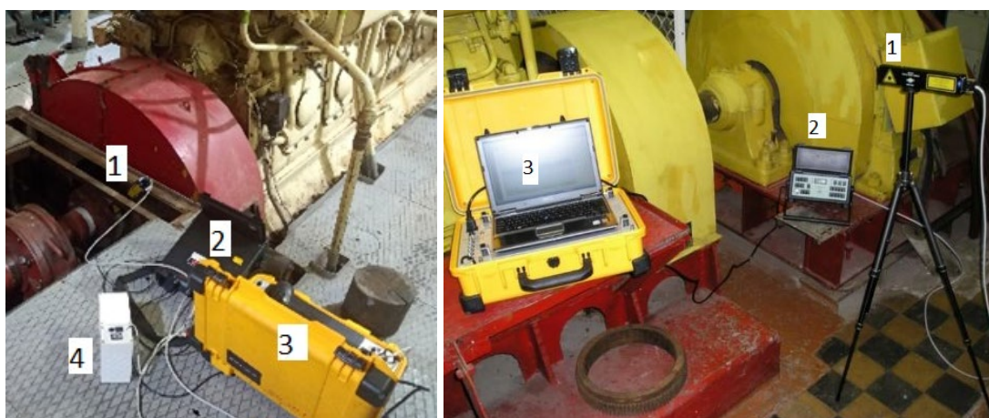
Рис. 1. Состав комплекта для измерения крутильных колебаний на основе лазерного виброметра 2523 («Брюль и Кьер»): 1 – доплеровский лазерный датчик; 2 – виброметр (АЦП); 3 – анализатор сигналов с ноутбуком; 4 – батарея для питания виброметра
