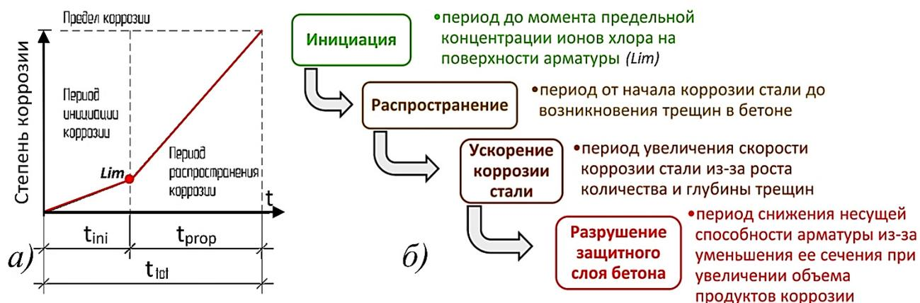
**Рис. 4. Стадии развития коррозионных процессов в арматуре**
