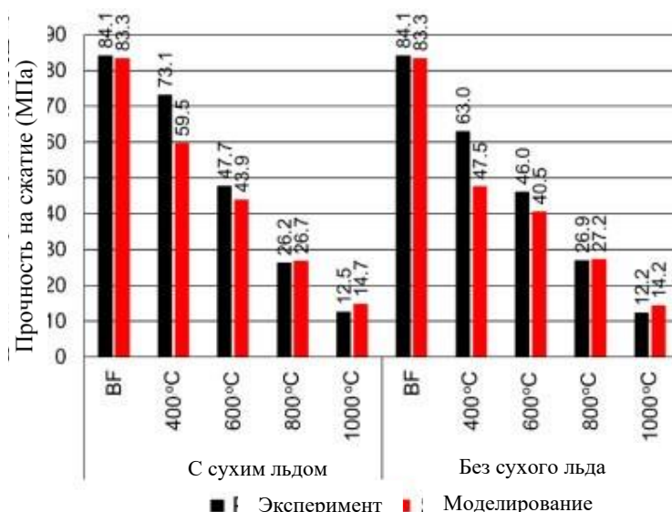
Рис. 7. Прочность на сжатие после нагрева с высокой концентрацией CO 2 при введении сухого льда и без него [17]
