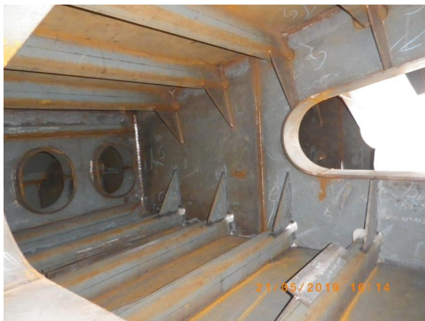
Рис. 8. Конструкция флора, вид изнутри
