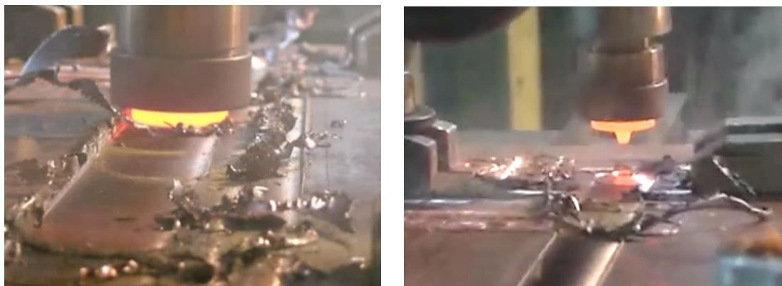
Рис. 1. Сварка трением с перемешиванием пластин из медного сплава
