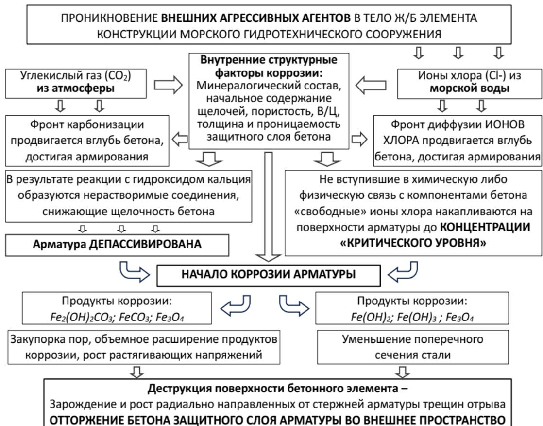
**Рис. 4. Схема механизмов химической коррозии арматуры в железобетоне**
