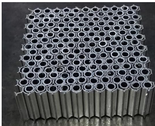
Рис. 3. Сотовые структуры со вставками-трубками
