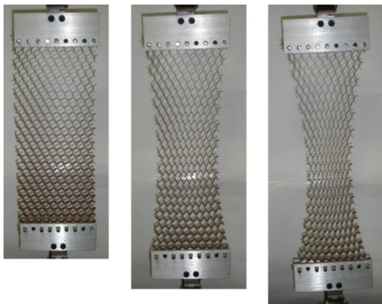
Рис. 1. Сотовые структуры Nomex, испытание сот на растяжение [10]
