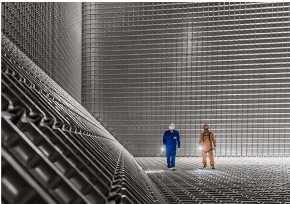
**Рис. 4. Внутреннее пространство грузовой мембранной ёмкости по технологии GTT**
