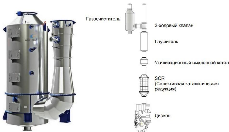
**Рис. 6. Внешний вид скруббера Wärtsilä V-SOx и его расположение в схеме выхлопной системы судна**
