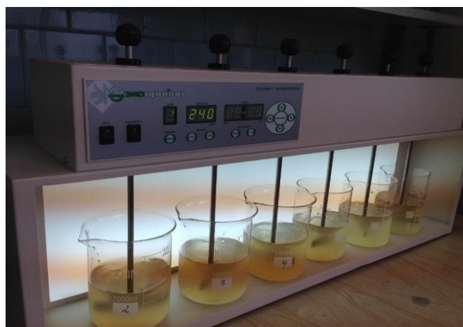
Рис. 1. Шестиместный флокулятор ПЭ-0244 для проведения пробного коагулирования при очистке природных и сточных вод
