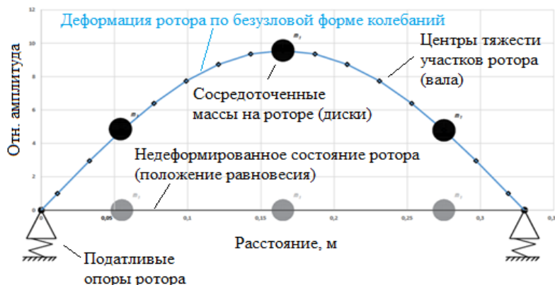
Рис. 6. Расчётная схема системы «ротор – подшипники»: многодисковый двухопорный ротор
