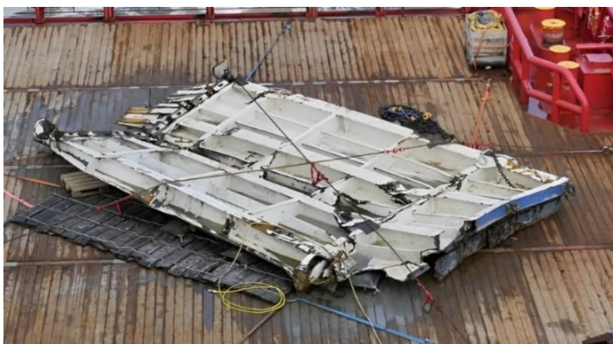
Рис. 2. Поврежденная носовая аппарель парома Estonia
