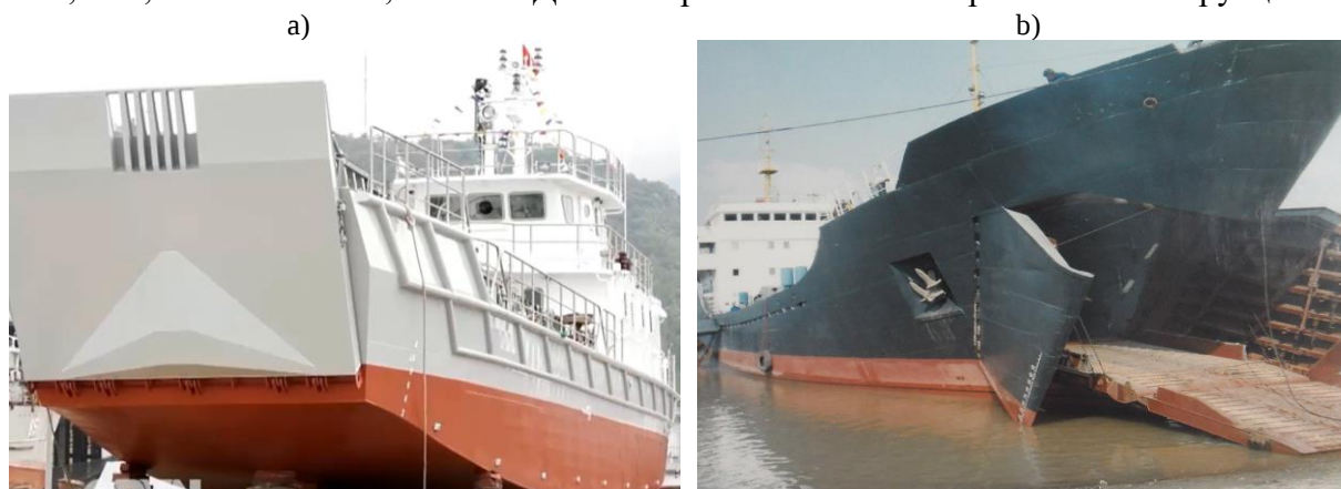
Рис. 1. Конструктивные схемы носовых аппарелей: а) односекционная; б) двухсекционная
