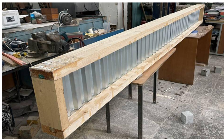
Рис. 1. Опытный образец металлодеревянной двутавровой балки
