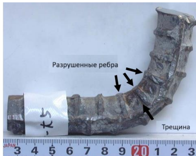
Рис. 1. Разрушение арматурного стержня в процессе гибки арматуры [4]
