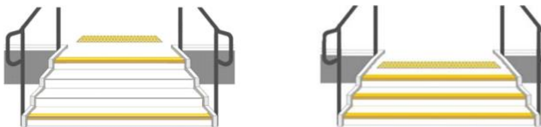
Рис. 12. Маркировка ступеней наружных лестниц: а) маркировка крайних ступеней лестниц; б) на лестницах в две и три ступени маркируется каждая ступень
