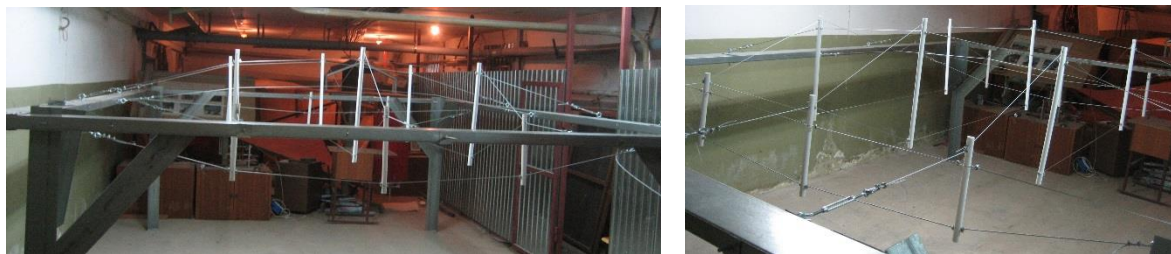
Рис. 4. Общий вид лабораторной модели вантовой конструкции
