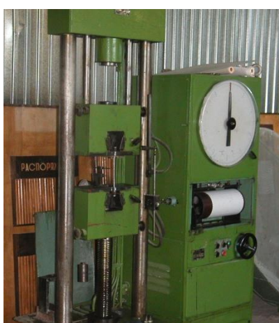
Рис. 3. Определение прочностных и жесткостных характеристик стальных тросов на испытательной машине Р-10: общий вид испытательной машины и образцы троса
