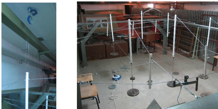
Рис. 5. Испытание модели вантовой конструкции
