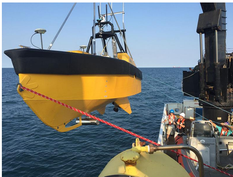
Рис. 1. Спуск БЭК «С-WORKER 5» с помощью палубного крана
