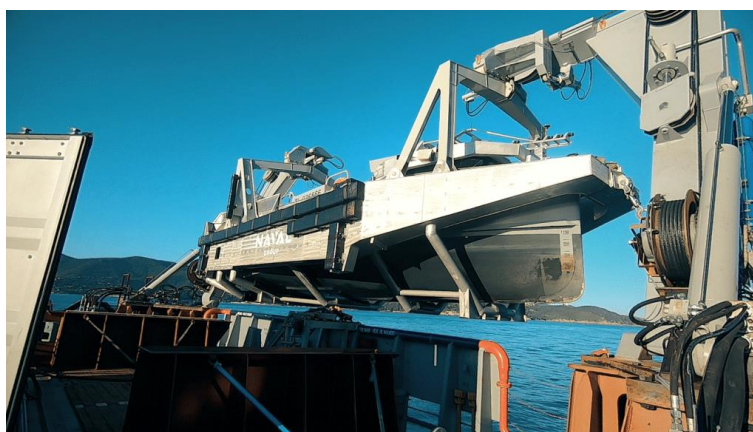
Рис. 5. Спуск БЭК «Inspector 125» с помощью специализированного СПУ
