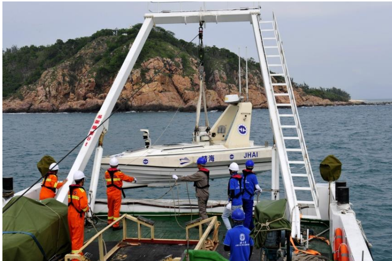
Рис. 2. Спуск БЭК «M80» с помощью П-образной рамы
