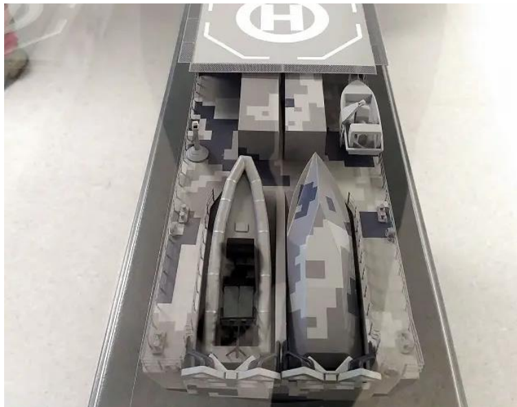
Рис. 4. СПУ для БЭК типа слип, предлагаемое компанией Saab [23]
