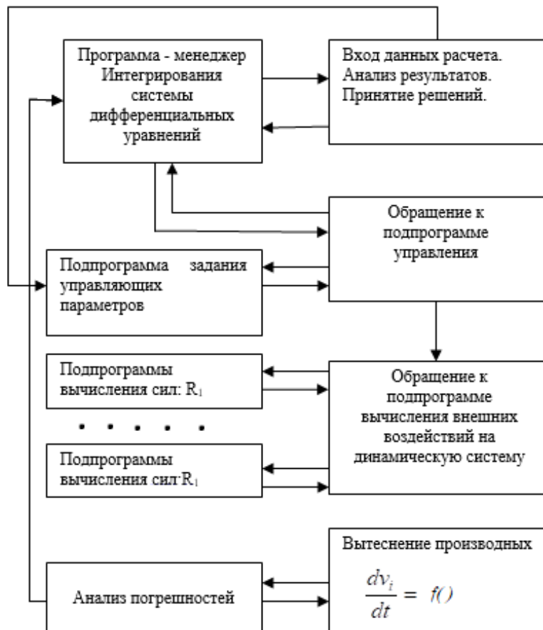
Рис. 6. Укрупненная блок-схема интегрирования системы дифференциальных уравнений Fig. 6. An enlarged block diagram of the integration of a system of differential equations
