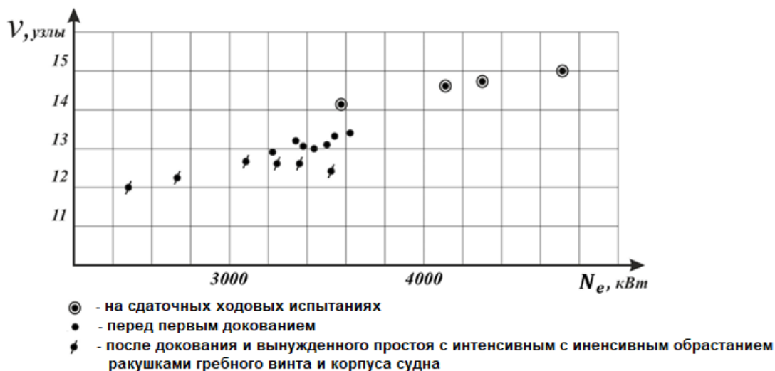
Рис. 1. Замеры скоростей т/х «Капитан Каратаев» при соответствующих мощностях: на сдаточных ходовых испытаниях; перед первым докованием; после докования и вынужденного простоя с интенсивным обрастанием ракушками винта и корпуса судна
