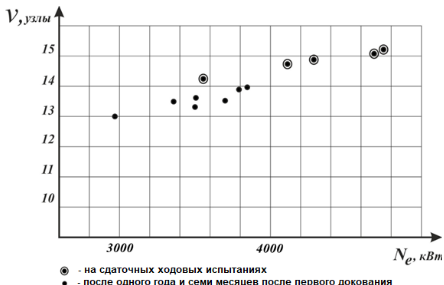
Рис. 2. Замеры скоростей т/х «Капитан Руднев» при соответствующих мощностях: на сдаточных ходовых испытаниях; спустя 1 год и 7 месяцев после первого докования
