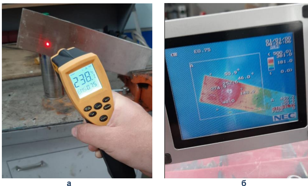
Рис. 1. Измерение температурного поля с помощью инфракрасного пирометра Тестан ТМ900 (а) и тепловизионной камеры Nec tn9100wb (б)
