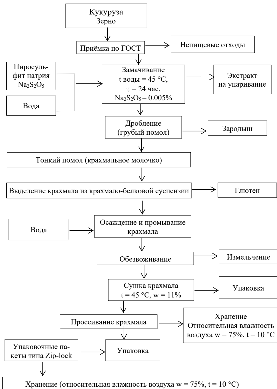
Рис. 2. Принципиальная технологическая схема по производству крахмала из зерна кукурузы (сорта Славянка, Южанка)
